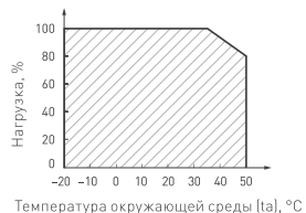
Рис. 2. Максимальная допустимая нагрузка, % от мощности источника
