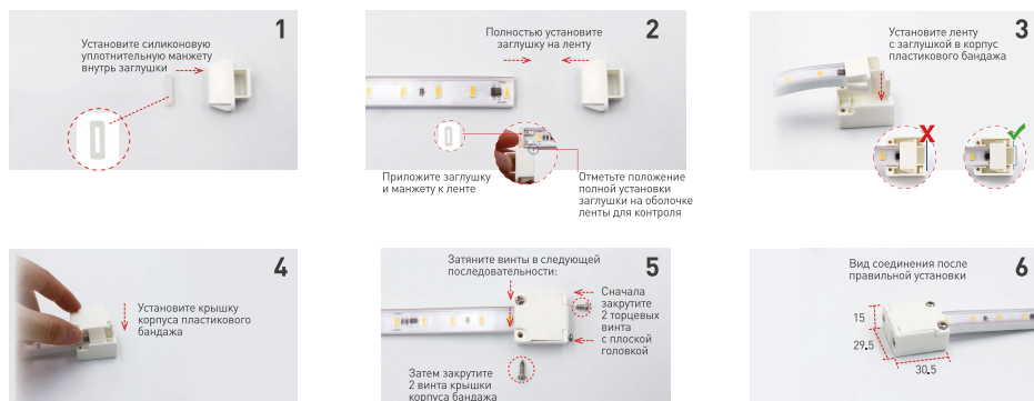
Рисунок 1. Установка концевой заглушки
