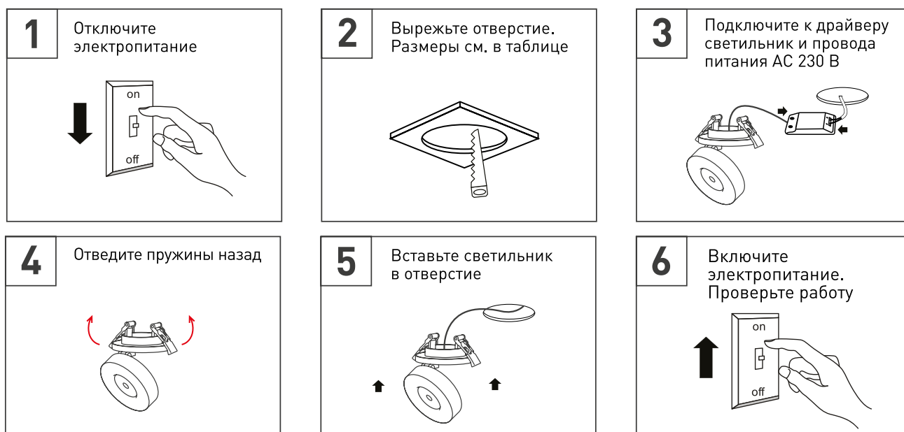
Рис. 2. Установка и подключение светильника
