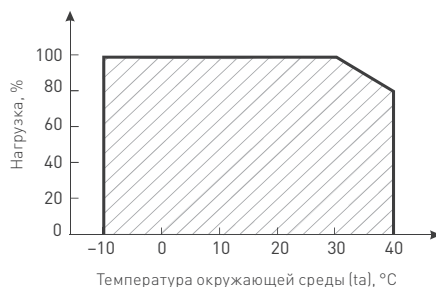
Рис. 2. Максимальная допустимая нагрузка, % от мощности источника
