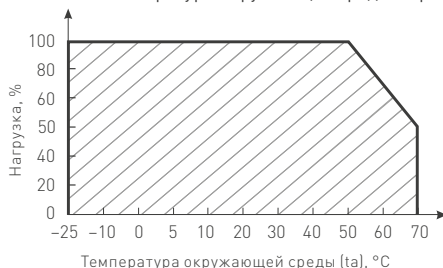
Рис. 2. Максимальная допустимая нагрузка, % от мощности источника
