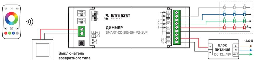
Рис. 2. Схема подключения диммера для управления RGBW-нагрузкой
