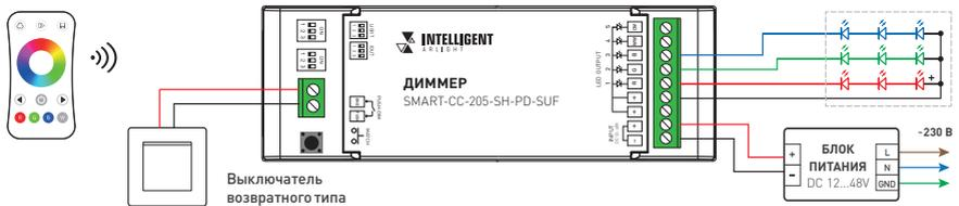
Рис. 3. Схема подключения диммера для управления RGB-нагрузкой
