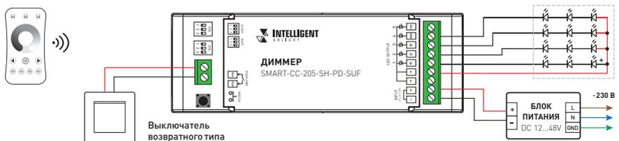
Рис. 5. Схема подключения диммера для управления DIM-нагрузкой
