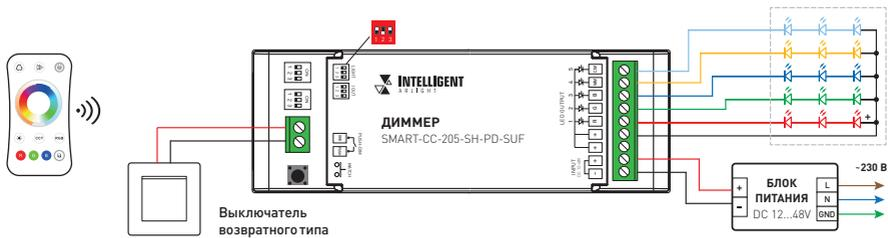
Рис. 1. Схема подключения диммера SMART для управления RGB-MIX-нагрузкой
