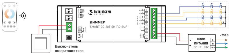
Рис. 4. Схема подключения диммера для управления MIX-нагрузкой
