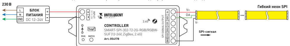
Рис. 5. Схема подключения контроллера SMART-SPI для управления SPI-неоном
