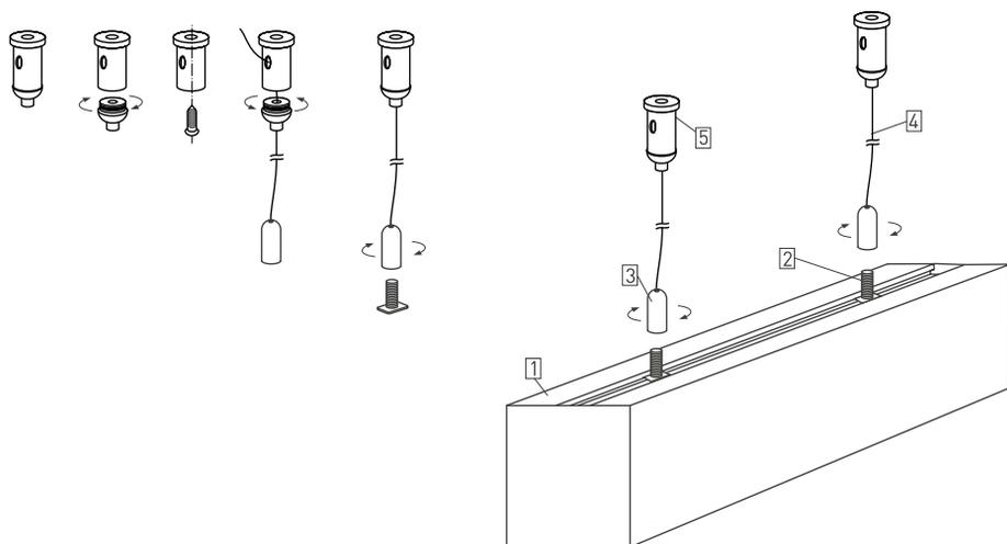
Рис. 2. Монтаж светильника
